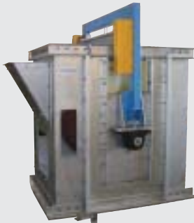
Fußstation mit Gewichtspann- vorrichtung Bottom station with counter weight tensioning device
