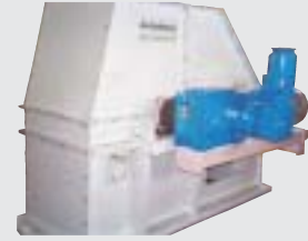
Kopfstation mit Kegelrad- Aufsteck- getriebemotor und Kriechantrieb Head station with geared motor drive including inching drive.
